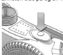
Ved å i kort tid trykke på knappen, er det mulig å slå over mellomto ulike styrker luftstrøm: 160 l/min – 210 l/min. Moduset for maksimal luftgjennomstrøming gir brukeren større beskyttelse. Dersom temperaturen i omgivelsene er lav, kan det imidlertid være ubehagelig når luftstrømmen er stor.
