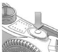
S kratkim pritiskom na gumb lahko preklapljate med dvema nivojem pretoka zraka 160 l/min – 210 l/min. Režim maksimalnega pretoka zraka omogoča višjo stopnjo zaščite uporabnika. Pri nižji temperaturi je lahko višji pretok zraka neprijeten.
