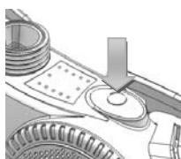
Durch kurze Betätigung der Drucktaste kann zwischen den beiden Stufen des Luftstromes, 160 l/min – 210 l/min, umgeschaltet werden. Der höhere Luftstrom gewährt dem Benutzer ein höheres Schutzniveau. Bei niedrigen Temperaturen kann jedoch eine höhere Strömung unangenehm sein.
