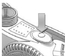
Krótkie naciśnięcie przycisku umożliwia przełączenie pomiędzy dwoma poziomami przepływu powietrza 160 l/min. – 210 l/min. Nastawienie maksymalnego przepływu powietrza zapewnia wyższy poziom ochrony użytkownika. Jednakże przy wyższych temperaturach powietrza jego zwiększyony przepływ może być nieprzyjemny.
